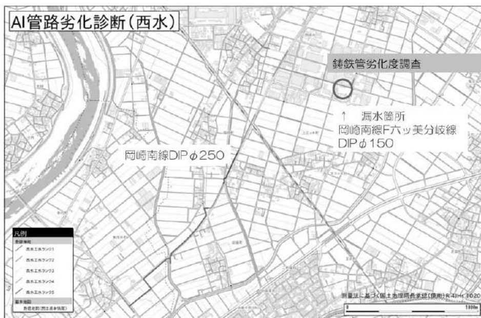
図4 岡崎南線 F 六ツ美分岐線の AI 管路劣化予測診断の結果
