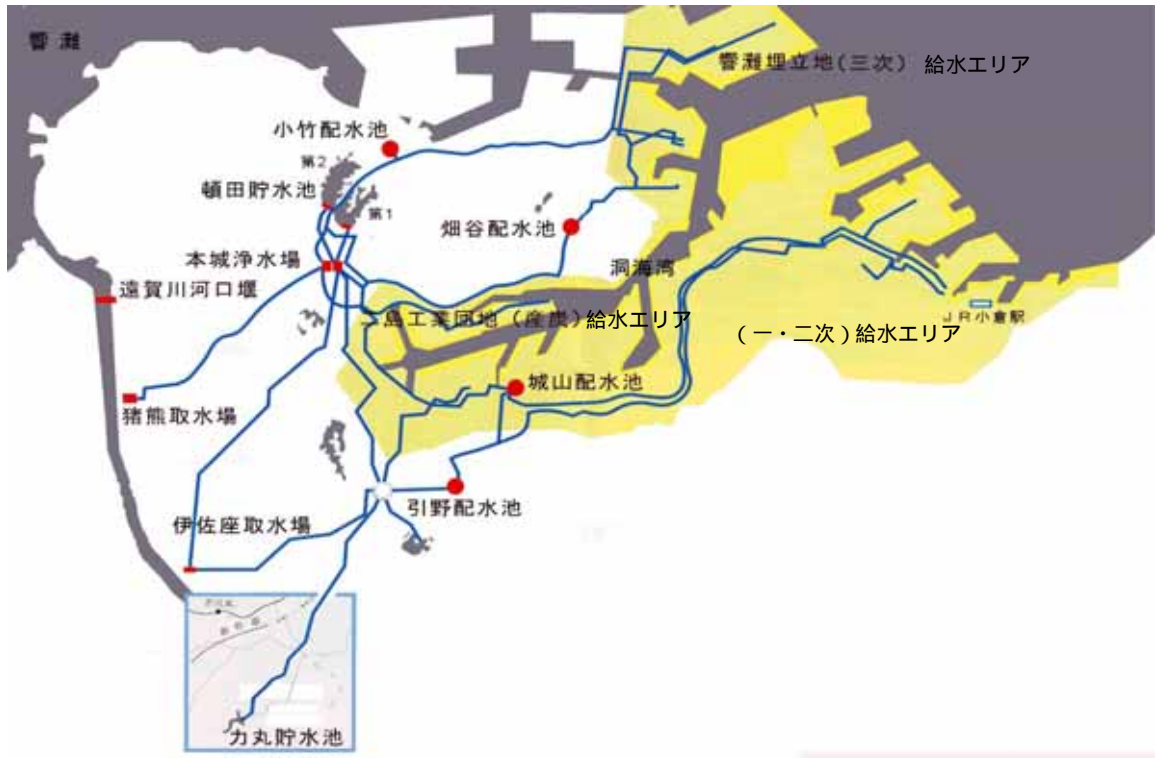
工業用水道主要施設系統図
